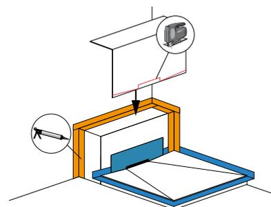
Bauseits Ausschnitt für den Wandablauf und die Gefällestrecke in die Mineralwerkstoffoberfläche für den SEAT sägen.
