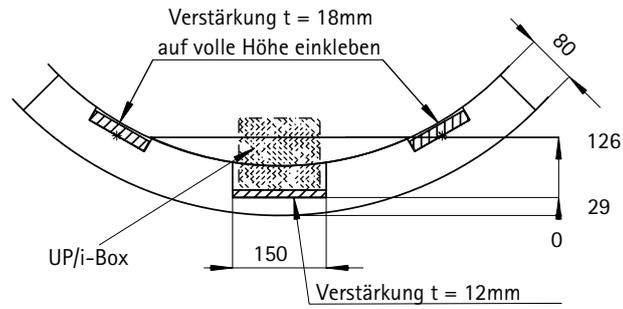
Varianten zur Positionierung der UP- oder i-Box:
