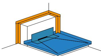
Dichtmanschette des Wandablaufs am SEAT-Grundkörper und auf dem Systemboard verkleben.
