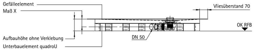
Einbau waagerechter Ablauf, Sperrwasserhöhe 50 mm
