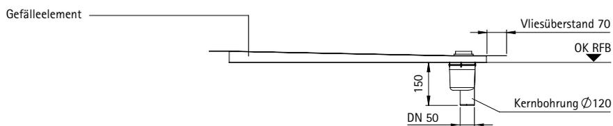
Einbau waagerechter Ablauf, Sperrwasserhöhe 35 mm
