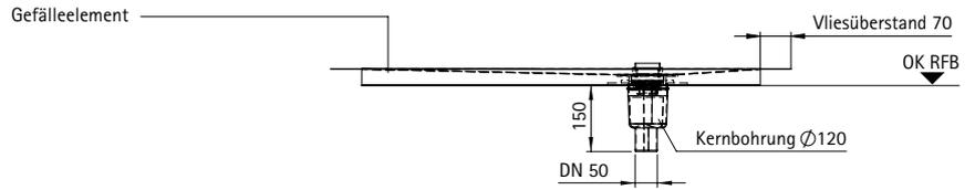
Einbau waagerechter Ablauf, Sperrwasserhöhe 35 mm
