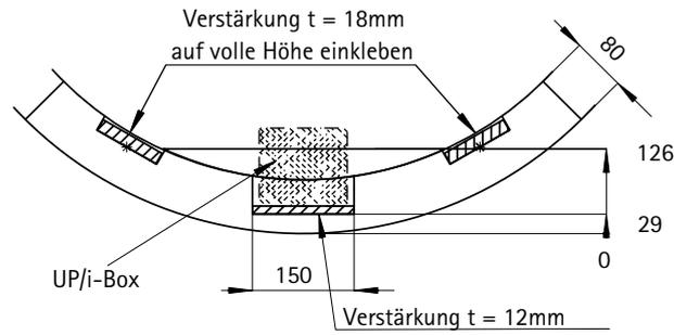
Varianten zur Positionierung der UP- oder i-Box:
