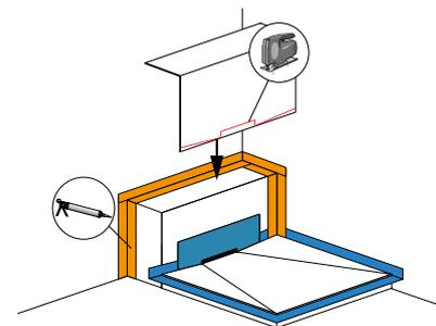
Bauseits Ausschnitt für den Wandablauf und die Gefällestrecke in die Mineralwerkstoffoberfläche für den SEAT sägen.
