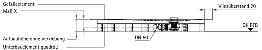
Einbau waagerechter Ablauf, Sperrwasserhöhe 50 mm
